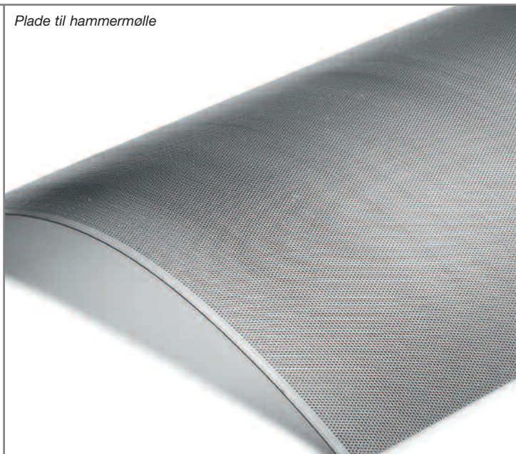
3 mm runde huller i 3 mm tykt materiale med 4 mm deling = 51% luft
